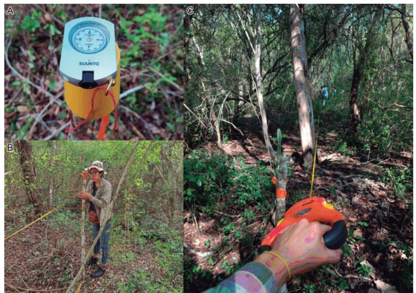
Figura 6. A. Brújula estableciendo la dirección del eje Y (0° Norte). B. Direccionamiento de la apertura de los ejes del perímetro de la PPM. C. Apertura de brecha de la PPM.
