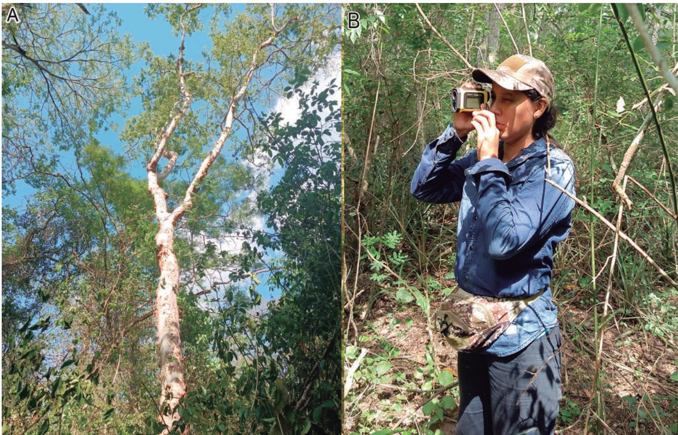
Figura 13. A. Árbol emergente. B. Medición de la altura total mediante un hipsómetro láser Nikon Forestry Pro.
