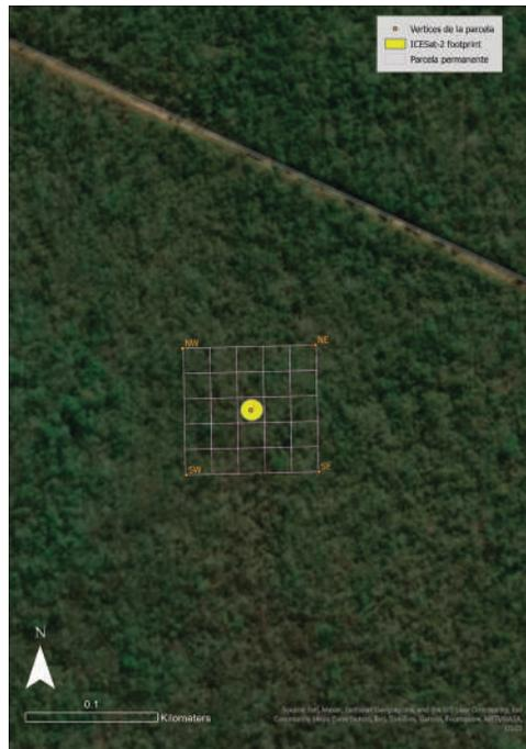
Figura 5. Geometría de la PPM con relación a las huellas de LiDAR del sistema ICESat-2.
