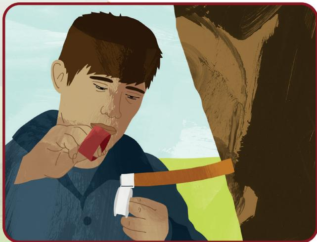
**7** En la punta exterior del caño colocar cinta teflón para asegurar un cierre hermético del tapón. Ello evitará que filtre el agua o aceite. Dar unas 6 vueltas con teflón a la parte tarrajada del caño.
